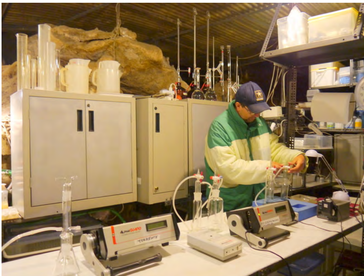
Misurazioni puntuali della concentrazione del radon nelle acque
