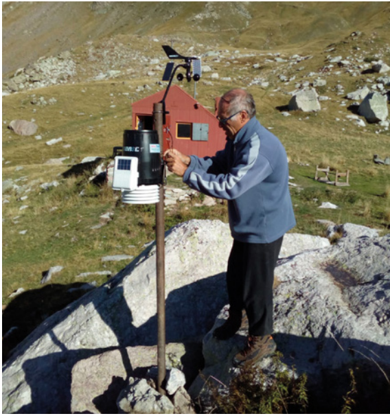
Fig. 1 La nuova stazione meteo presso la Capanna Saracco-Volante. Misura piovosità, T, RH, vento, pressione atmosferica. (PH. U. Lovera)
