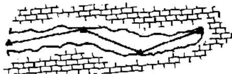
Fig. 3 - Rilievo col Topofil
