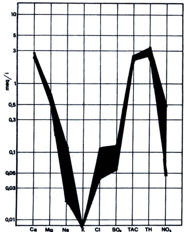
Diagramma di Schoeller delle acque della Taramburla : campo di variazione in dieci cicli di misure. Valori delle concentrazioni ioniche in milliequivalenti/litro ( dis. G.Calandri).
